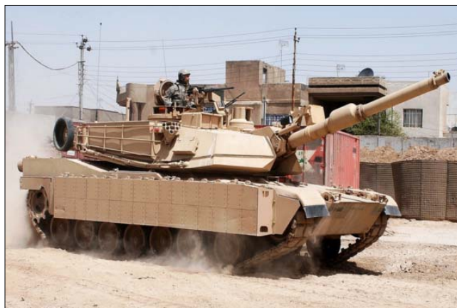
Ненажерливий танк. Споживання палива Abrams на пересіченій місцевості – приблизно в 57 галонів на годину (216 літрів). Фото з відкритих джерел
