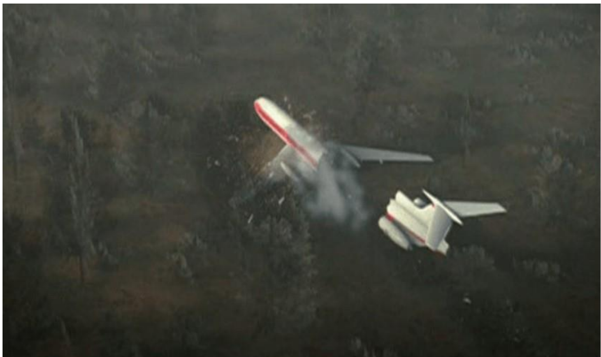
Експертна реконструкція супутникових знімків вибуху в лівому крилі, закрилках і центроплані літака Ту-154М до зіткнення з землею.
